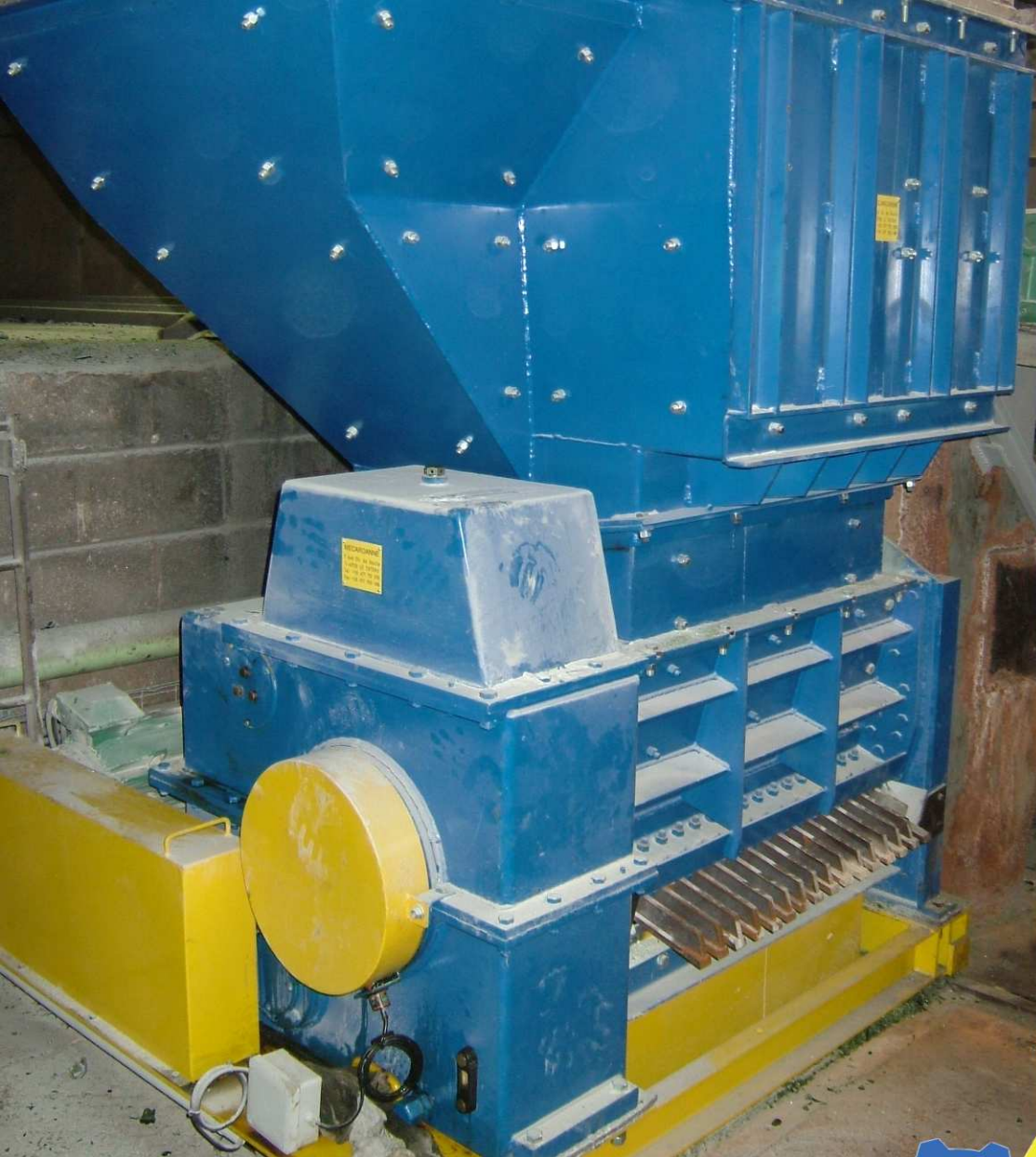
Unité de broyage de bouteilles de verre broyeur à rotors dentés type C200x800
